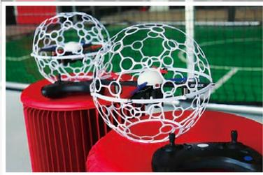
球状のフレームに覆われたドローンを使用し、コントローラーで飛ぶ高さや前後左右の方向を操作します。
